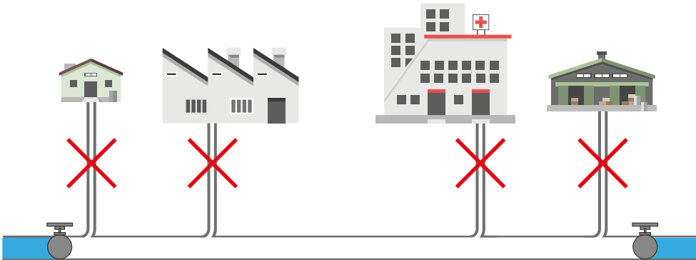
SANS SYSTÈME ABS L'eau est coupée entre les 2 vannes
