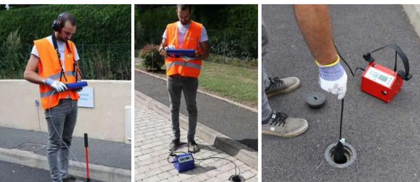
Installé sur les points d'écoute prélocalisés, le LOKAL 400 est un appareil polyvalent qui permet de corréler et localiser les fuites, en évoluant vers l'écoute au sol. Simple à utiliser, cette solution optimise l'intervention et permet de localiser rapidement la fuite. Reconnu pour sa rapidité d'utilisation, sa précision et pour la corrélation multi-points, il offre une détection fiabilisée, même la journée par grand trafic.
