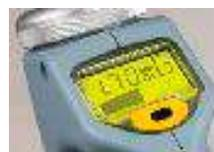
En mode Genny, le C.A.T détecte un signal induit par le Genny.
