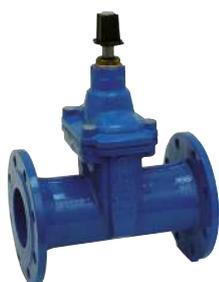
Série longue / Fabrication selon EN 1171 / Écartement selon DIN 3352 - F5 / Perçage de brides selon EN 1092-2 / Corps et chapeau en fonte ductile revêtu époxy épaisseur 250 $\mu$  / Opercule en fonte ductile surmoulé élastomère EPDM / Manoeuvre par carré 30 x 30 mm FAH
