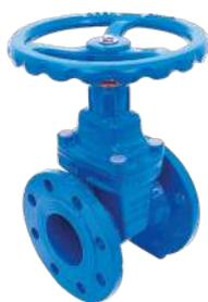
Série courte / Fabrication selon EN 1171 / Écartement selon DIN 3352 - F4 / Perçage de brides selon EN 1092-2 / Corps et chapeau en fonte ductile revêtu époxy épaisseur 250 $\mu$  / Opercule en fonte ductile surmoulé élastomère EPDM / Manœuvre par volant FSH / Fourni avec volant et chapeau d'ordonnance
