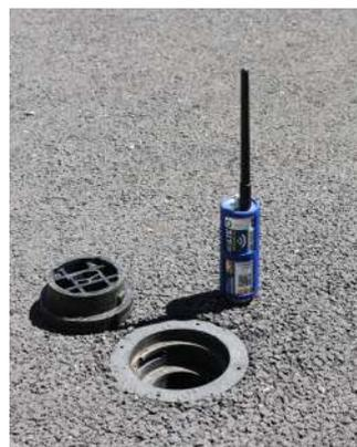
Installés en maillage sur le réseau d'eau sur les vannes, bouches à clé ou regard, les prélocalisateurs forment un système de surveillance permanent ou provisoire. Ils enregistrent automatiquement les bruits de nuit pour réduire les temps d'astreinte et permettent la détection précoce d'une fuite. Avec la fonction corrélation qui précise la zone de fuite, la réactivité d'intervention est optimale.
