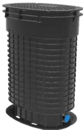
Le regard de comptage abrite et protège le compteur d'eau et la robinetterie. Il est enterré sous le trottoir ou dans le jardin, permettant son accessibilité dans le domaine public ou privé. C'est la solution à privilégier pour les réseaux en renouvellement, encombrés ou ceux avec un accès difficile en limite de propriété. Les regards protègent le compteur du gel grâce à leur isolation thermique et bénéficient des calories puisées en profondeur dans le sol par la partie enterrée.
