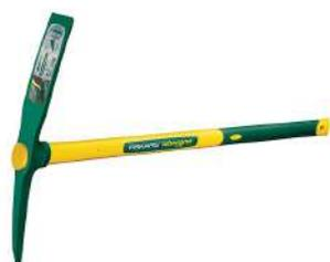
Idéal pour les travaux de terrassement, de voirie, etc... / Pointe diamant et panne affûtée, trempées pour une meilleure résistance à l'usure / Un côté panne pour creuser et un côté pic pour dépierrer / Douille ronde Ø 47 / Poids tête : 2 kg / Hauteur tête : 550 mm / Largeur de tête : 60 mm / Manche : 1000 mm
