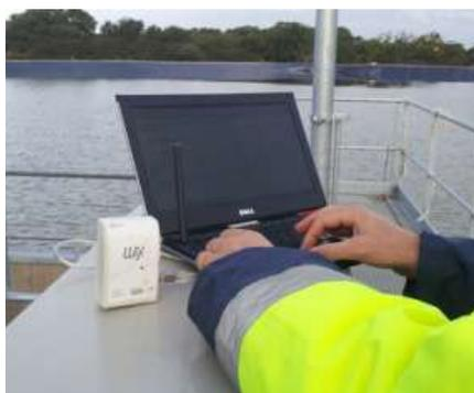
La version Remote du logiciel Avelour permet d'activer à distance, plusieurs correctifs aux configurations des appareils de mesures. Ces systèmes autonomes et à communication cellulaire, permettent de mutualiser les nouvelles configurations Avelour avec la plateforme Ijitrack ou l'outil de supervision client. La collecte des données selon les nouvelles configurations facilite l'optimisation du parc d'équipements du réseau, sans intervention des équipes terrain.
