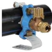
Les colliers à sangle s'adaptent à une large plage de diamètres de conduite et à tous les matériaux. Le serrage de la vis réalise la tension de la sangle, préalablement réglée par crantage au diamètre de la conduite.
