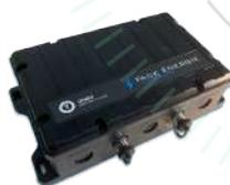
**Pack énergie grande capacité**, pour accroître l'autonomie des capteurs
