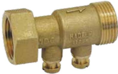
Comme le précise la norme EN 1717, le clapet de non retour antipollution EA est un dispositif de protection mécanique contrôlable, muni d'un obturateur conçu pour permettre la circulation d'eau dans une seule direction.
