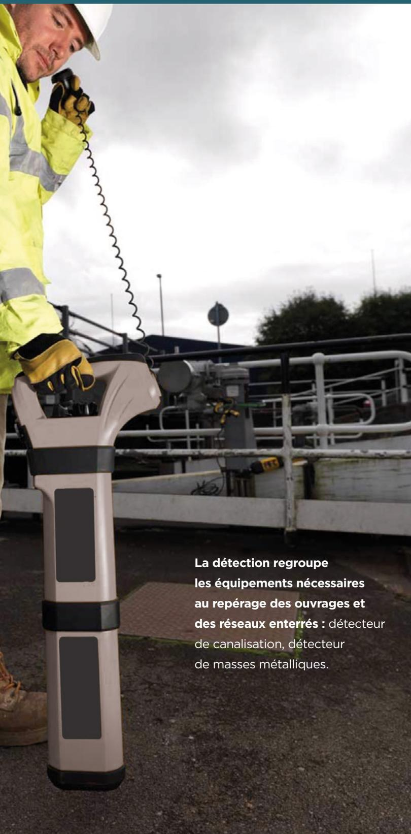
La détection regroupe les équipements nécessaires au repérage des ouvrages et des réseaux enterrés : détecteur de canalisation, détecteur de masses métalliques.
