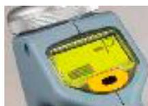
En mode 50 Hz, le C.A.T détecte le signal émis par un câble sous tension.
