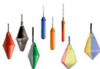
Poire de niveau / Contrôleur de niveau type poire : Flotteur polypropylène / Version biconique à 5 compartiments étanches / Contact argent microrupteur inverseur 8A 250VAC / Lest intérieur / Densité 0,5 à 1,15 / Température maxi 70°C
