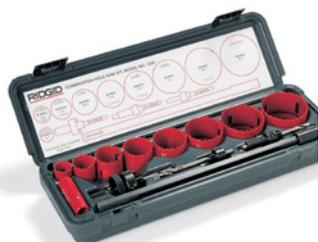
Scie cloche pro bi métal / Construction bi métal Ø 19-22-29-35-38-44-57-64, bord de coupe M3 HSS / Pas variable 3/5 TPL, profondeur de coupe de 38 mm / Inclinaison positive des dents / Livré en coffret de 9 scies cloches + 3 arbres + 1 allonge
