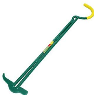
Marteau d'égoutier / Outil 3 en 1 / Pour soulever les plaques d'égout / Côté "bec" pour soulever les plaques (ou tampons) / Côté "marteau" pour taper sur les plaques afin de les décoller de leur support / Côté "poignée" pour tirer la plaque hors de la bouche d'égout / Section ronde de la poignée + gaine / Manche composé de 2 ronds en acier de 16 mm soudés / Poids total : 3,275 kg / Longueur totale : 900 mm
