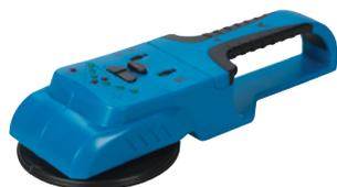
Détecteur de câble 3 en 1 / Détecteur portatif pour déceler les éléments de bois tels que montants et solives, les tuyaux et conduites en métal, ainsi que les câbles sous tension dans les murs, plafonds et sols / Signaux sonores et LED / Sensibilité de détection réglable / 1 pile 9 V (PP3) requise
