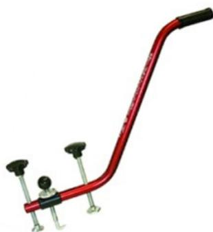
Pioche d'égoutier / Pour manipuler les plaques d'égout / Côté panne pour dégager l'enrobé des bords de la plaque / Côté crochet pour soulever et faire glisser la plaque / Poids : 1,3 kg / Hauteur totale : 900 mm
